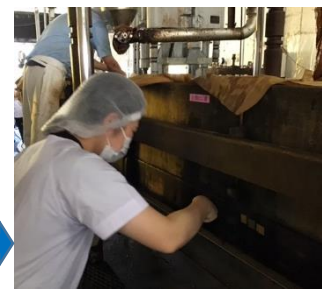
【もろみを木枠に流し込み、手作業で均して布で覆う（繰り返す）→圧搾されて生醤油が下からしみ出す】
