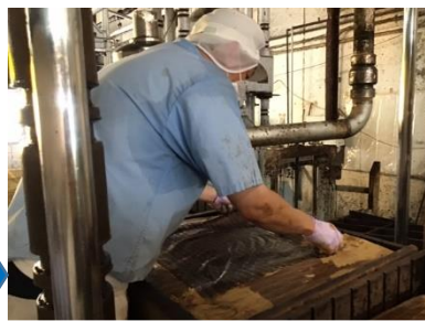
【もろみを木枠に流し込み、手作業で均して布で覆う（繰り返す）→圧搾されて生醤油が下からしみ出す】
