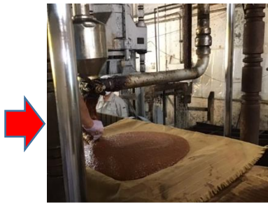
【もろみを木枠に流し込み、手作業で均して布で覆う（繰り返す）→圧搾されて生醤油が下からしみ出す】
